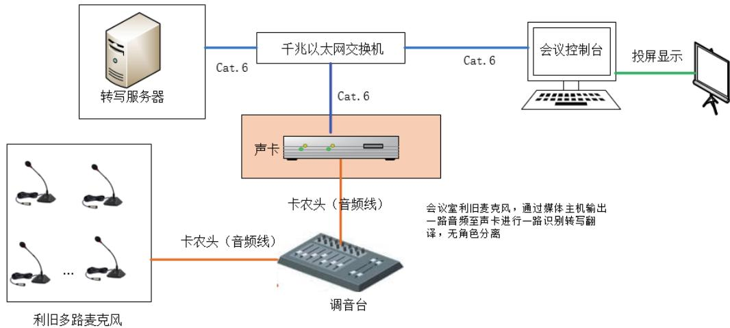
方案2：利旧麦克风直接通过卡侬头音频线直接连接声卡（讯飞定制声卡或者自备）
